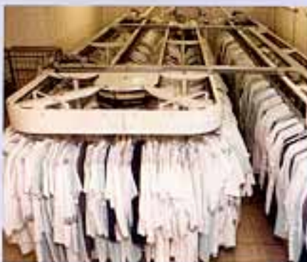
Rund um die Uhr ist der mannlose Kleiderschrank im Einsatz, der gegen einen Chip gewaschene Kleidungsstücke an die Mitarbeiter ausgibt.
