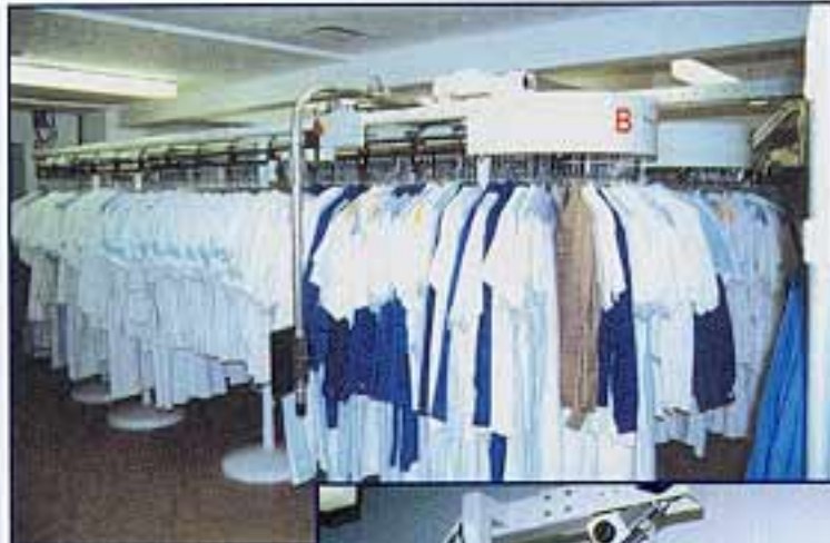
Die Personalbekleidung wurde chaotisch in die Speicher- und Transportanlage eingehängt und dabei gleichzeitig registriert. Ein Greifarm gibt die Kleidung bei Bedarf automatisch aus.
