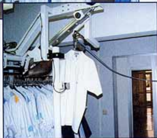
Die Personalbekleidung wurde chaotisch in die Speicher- und Transportanlage eingehängt und dabei gleichzeitig registriert. Ein Greifarm gibt die Kleidung bei Bedarf automatisch aus.
