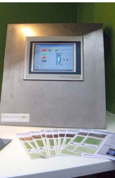
Mit der Visualisierungssoftware WG-Vision werden die Taktung, Bearbeitungsprozesse und Wege abgebildet.
