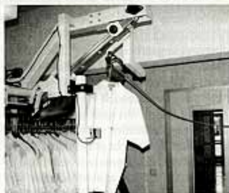
Eine Mitarbeiterin hängt die saubere Bekleidung ein (oben), ein Greifarm gibt den benötigten Kasack automatisch aus
